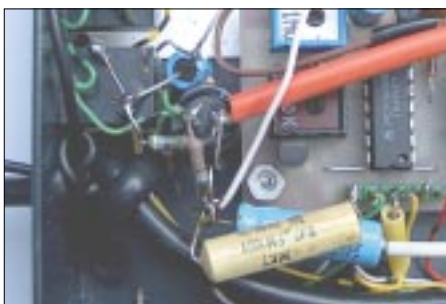
Unterbringung des Pufferverstärkers direkt an der Headset-Buchse im VOX-Gehäuse
