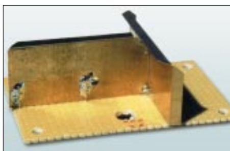
Bild 1: Lochrasterplatine mit Trennblechen, vor der eigentlichen Bestückung montiert
