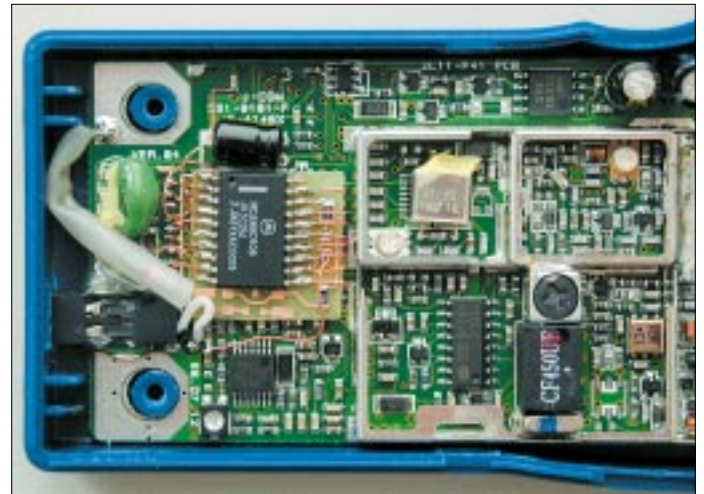
Bild 5: Dieser Bildausschnitt zeigt einige für die Modifikation wesentliche Details. Links ist der mit X2 markierte, zu entfernende Mikrocontroller zu erkennen, rechts oben der VCO in einem Abschirmrahmen mit dem zu wechselnden Kondensator X1, der Spule und braunem Trimmer.
