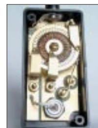
Der Zauber im schwarzen Kästchen: eine handgefertigte Spule mit vielen Abgriffen
