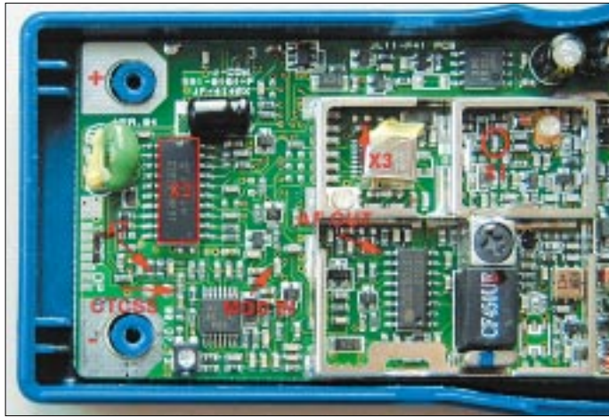
Bild 5: Dieser Bildausschnitt zeigt einige für die Modifikation wesentliche Details. Links ist der mit X2 markierte, zu entfernende Mikrocontroller zu erkennen, rechts oben der VCO in einem Abschirmrahmen mit dem zu wechselnden Kondensator X1, der Spule und braunem Trimmer.
